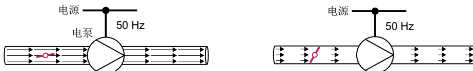
图 6-96 50 Hz 电源上使用泵和节流阀的流体控制
