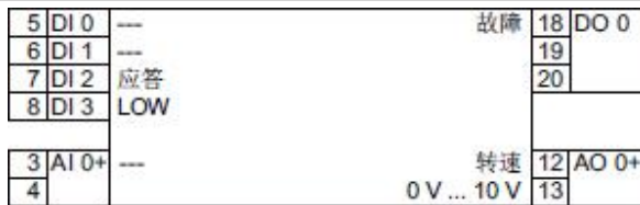
DI3 断开时选择 PROFIBUS 控制方式
