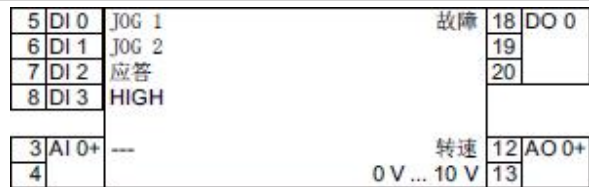
DI3 接通时选择点动控制方式
