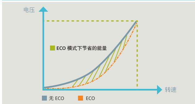
ECO 模式下，可确保在低动态负载下实现最佳性能和最低损耗，优化输出功率
