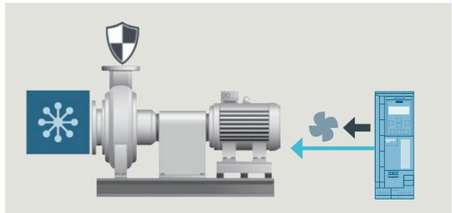
水管内的水结冰会损坏水泵。启用霜冻保护功能后，如果环境温度低于某一设定阈值，电机会自动旋转以防止水结冰
