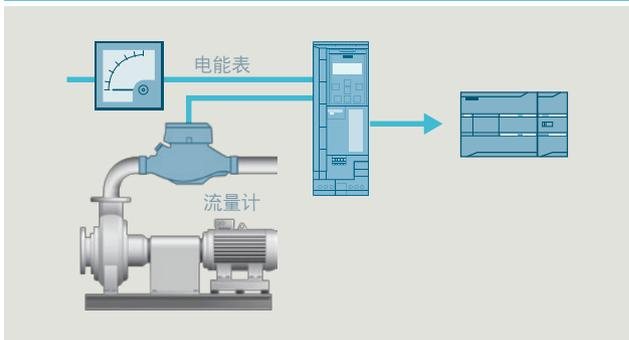
无需借助功率测量装置或流量计进行能耗与流量监控，变频器具备估算功能，并可以反馈至控制器
