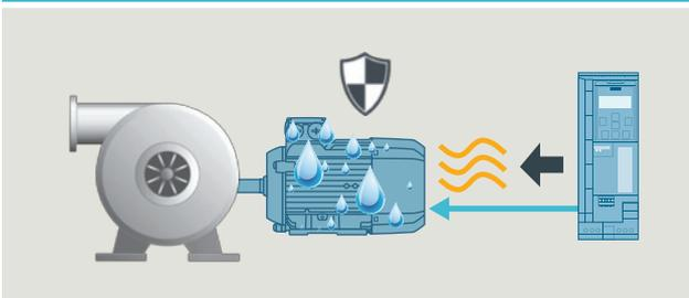
电机在潮湿、寒冷的环境中会产生冷凝，导致电机故障。通过稍微提高工作间断时电机表面的温度，可以避免这一问题
