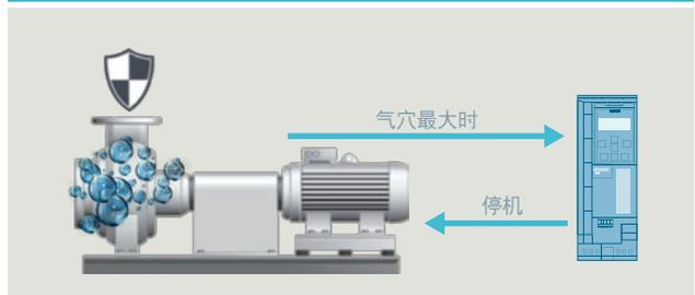
气蚀会损坏水泵叶轮，并产生噪音。气穴保护功能会在检测到气蚀现象时生成报警或故障，及时停机保护
